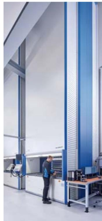
Auch große Aufträge werden durch intelligentes Vorpositionieren der benötigten Container in mehreren Lagerliften schnell und effizient abgearbeitet.
